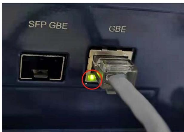
图 6.1.3 设备千兆网连接状态指示
