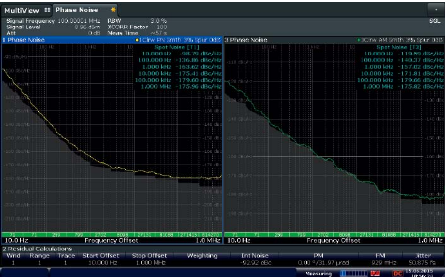
R&S®FSWP可同时测量相位噪声和调幅噪声。结果可显示在单独的窗口中，也可统一显示在一个窗口中。 (灰色区域：改善的R&S®FSWP互相关；绿色迹线：调幅噪声；黄色迹线：相位噪声)
