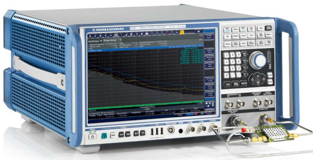
适用于测量放大器附加相位噪声并显示结果迹线的典型设置。
