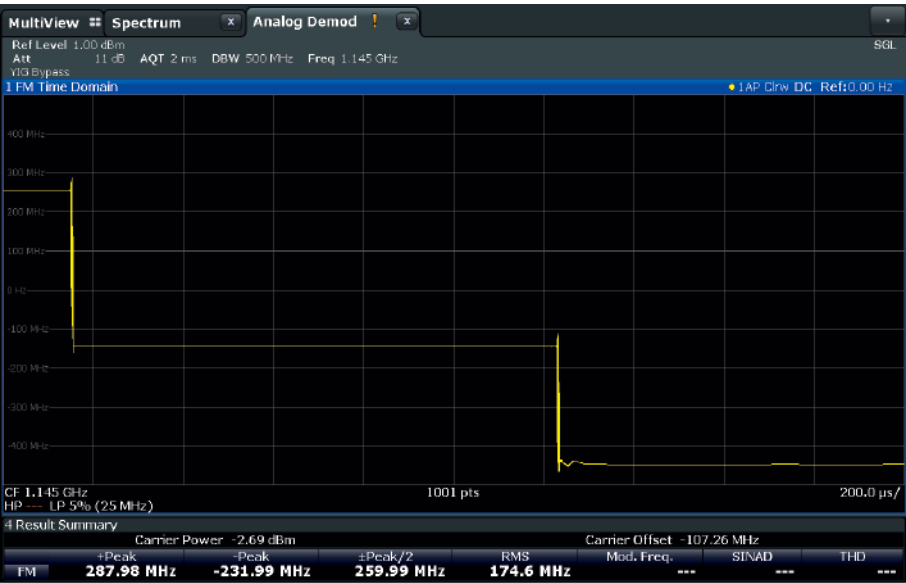
合成器的宽带频率分析。轨迹显示随时间变化的频率。这使用户能够测量切换时间和核查频率。
