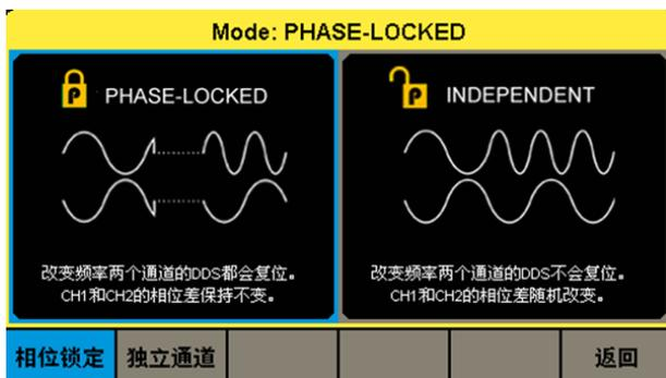
两种双通道工作模式，可以将单台 SDG6000X 作为两个独立的信号源使用，二者间互不影响，也可以使两个通道始终同步，保持相位上的联动
