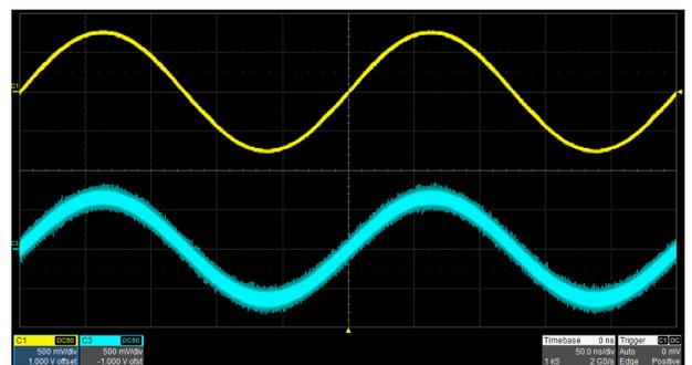
SDG6000X 可在内部将宽带噪声叠加到其它波形上，用于模拟最常见的真实信号
