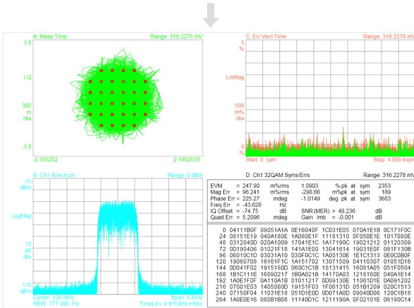
可生成常用的 ASK, FSK, PSK, QAM 等调制类型的 IQ 信号。创新的重采样技术使得 SDG6000X 可以在 250 Symb/s ~ 37.5 MSymb/s 范围内的任意符号率下获得优异的 EVM 性能。内建的数字正交调制器可将 IQ 信号的载波调制到 500MHz 范围内的任意频点
