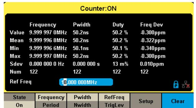
8 位高精度频率计，可测试 0.1Hz~400MHz 的频率范围
