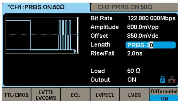
可快捷选取预设的电平逻辑如 TTL、LVCMOS、LVPECL 和 LVDS。差分模式可轻松将两通道设置成差分对输出
